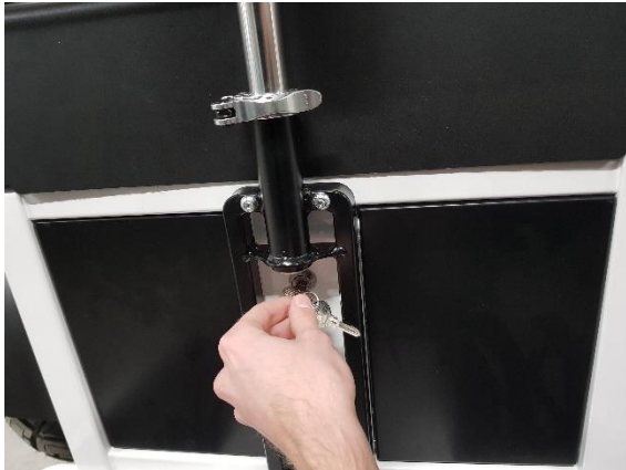
Stap 2: Ontgrendel elektrisch compartiment
